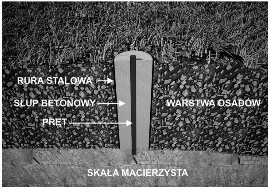
Rys. 3. Widok sposobu stabilizacji punktów geodezyjnych (opracowanie własne)
