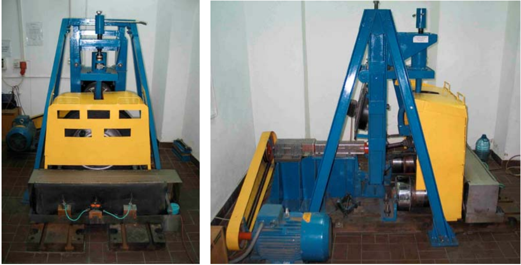
Rys. 4. Stanowisko pomiarowe do badań trwałościowych krążników Fig. 4. Test test rig for durability tests of rollers
