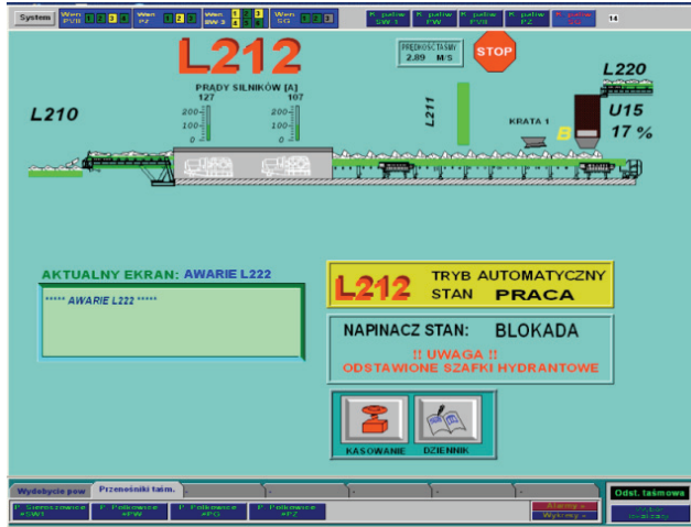
Rys. 3.5. Okno podglądu rejestracji poboru prądu na poszczególnych jednostkach napędowych przenośnika L-212
