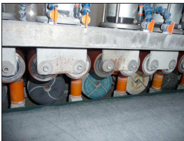
Rys. 8. Głowice szlifujące – granulacja diamentów 280, 400, 600, 800 (fot. J. Bury) Fig. 8. The polishing heads – granulation of diamonds 280, 400, 600, 800 (fot. J. Bury)
