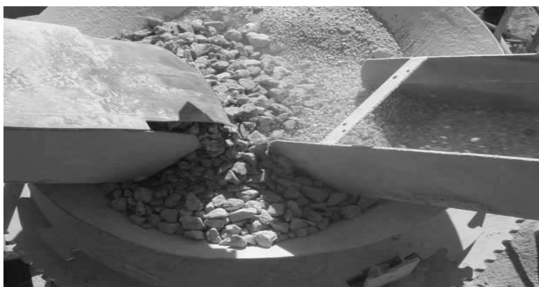
Rys. 2. Niewłaściwe rozprowadzenie podawanego materiału Fig. 2. Wrong feed distribution
