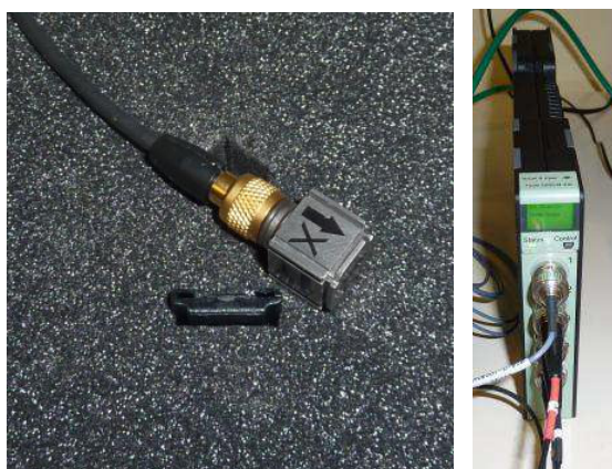
Rys. 2. Akcelerometr (po lewej) i kasetka pomiarowa (po prawej) Systemu PULSE firmy Brüel & Kjaer Fig. 2. Accelerometer (on left) and data acquisition hardware of PULSE System Brüel & Kjaer
