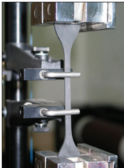
Rys. 4. Badanie wytrzymałości i wydłużenia gumy Fig. 4. Tensile strength testing
