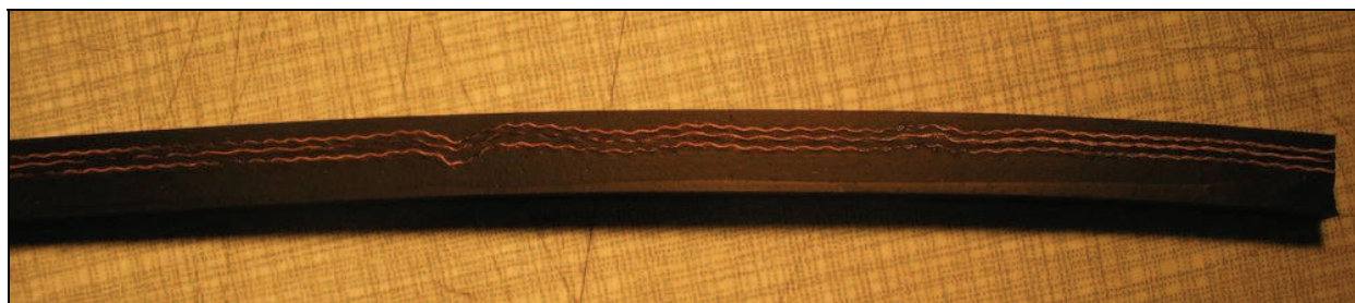
Rys. 5. Przekrój wzdłużny taśmy – nierównomierne napięcie przekładek Fig. 5. Longitudinal section of a belt – non uniform pre-tension of plies
