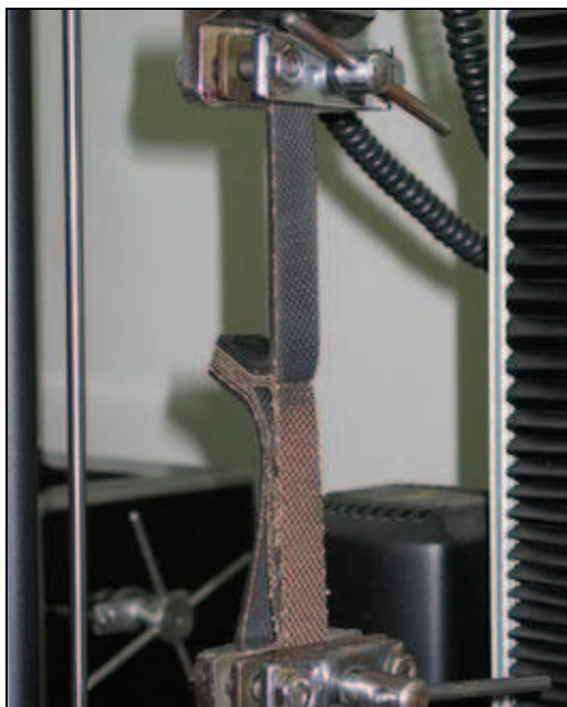
Rys. 3. Badanie wytrzymałości adhezyjnej Fig. 3. Adhesive strength testing
