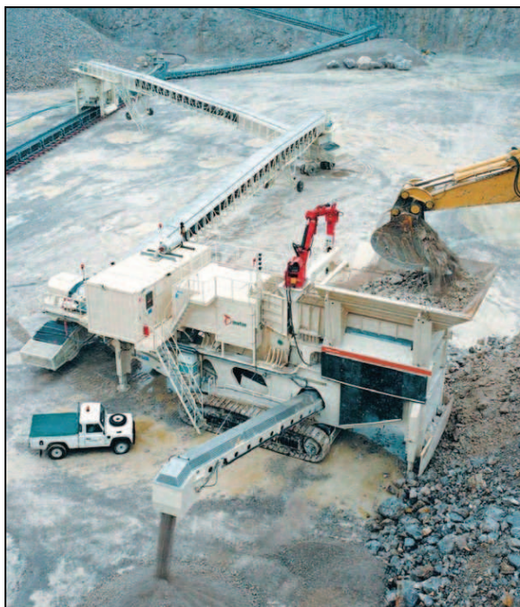
Rys. 1. Koparka – przejezdna kruszarka – przejezdny przenośnik – taśmociąg (fot. Metso) Fig. 1. Excavator – mobile crushing machine – mobile conveyor – conveyors (photo Metso)
