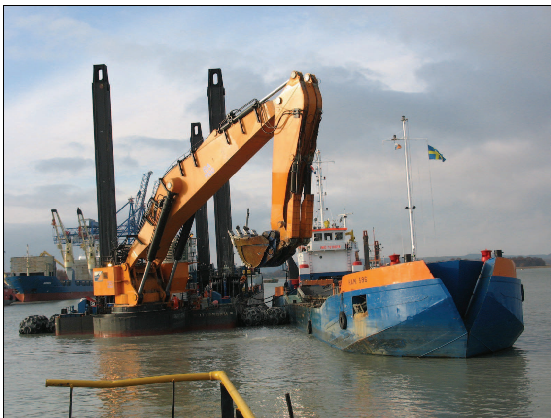
Rys. 2. Pływająca koparka łyżkowa w trakcie załadunku barki Fig. 2. Floating single-bucket excavator loading barge
