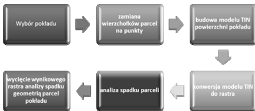
Rys. 4. Schemat procedury obliczenia nachylenia parcel eksploatacyjnych Fig. 4. Diagram of the procedure that returns slope of the exploited parcels
