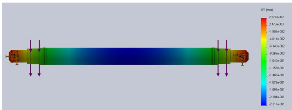
Rys. 11. Pionowe przemieszczenia osi krążnika K2 Fig. 11. Vertical displacement of idler shaft (K2)
