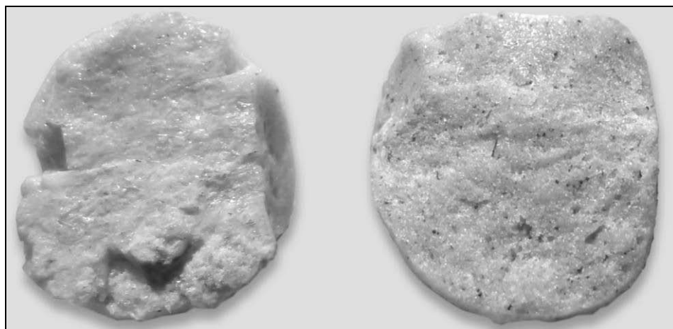
Rys. 3. Widok ziaren kruszywa wyprodukowanych wg receptury 3 (po lewej) i 6 (IMBiGS, 2014) Fig. 3. Aggregate grains produced according to the recipe 3 (left) and 6 (IMBiGS, 2014)
