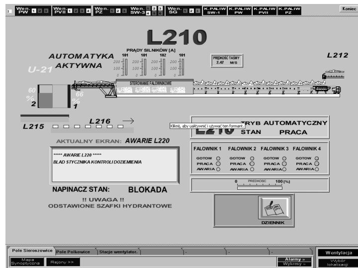
Rys. 6. Okno podglądu rejestracji poboru prądu na poszczególnych jednostkach napędowych przenośnika L-210
